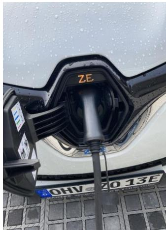
Dieses Fahrzeug kann an Ladesäulen mit Typ-2 Anschluss mit maximal 22 kW geladen werden. Im Kofferraum liegt ein Ladekabel bereit.
